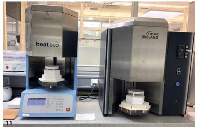
Abb. 8 und 9 Rohlinge aus Zirkonoxid. Abb. 10 Fertig gesinterte Rohlinge. Abb. 11 Der Sinterofen heatDuo von Dgudent und die imes icore Fräsmaschine von Wieland.
